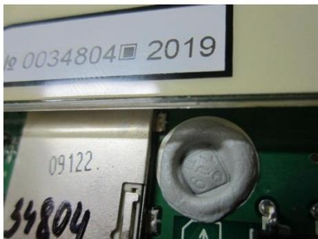
Рисунок 3 – Место пломбирования
