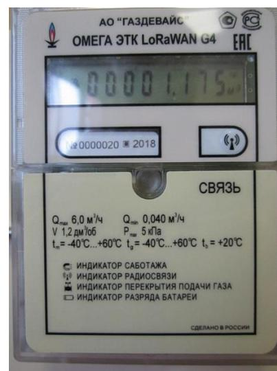
Рисунок 2 – Табличка счетчика газа
